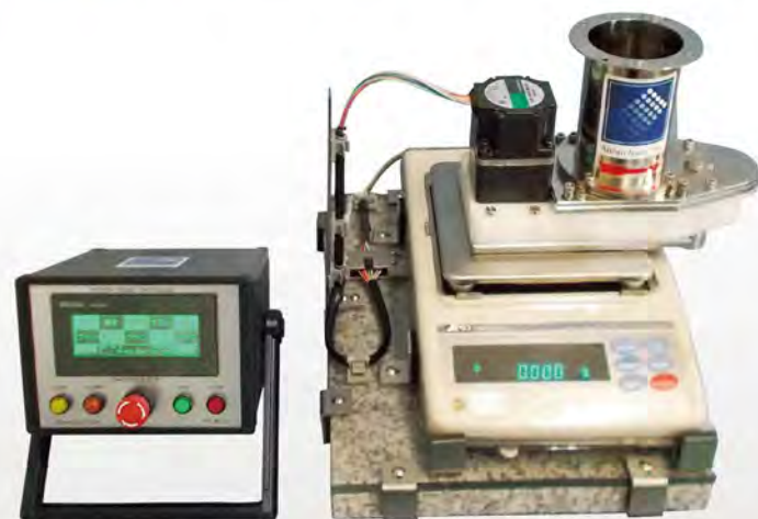
専用コントローラー フィーダー TF-70-AD・高精度電子天秤 (簡易風防、除振台はオプション)
